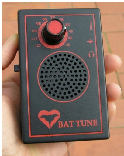
Foto 1.- Detector heterodí Bat Tune , versió 2.
